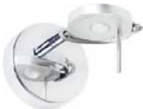
BOREAL-1 Foco metálico LED 6w. Óptica orientable de Ø100mm. Alimentación: 100/ 250v. 50/60Hz Consumo: 6w., 1x400lm, 3000k. Dimensiones: Ø100x70mm. Color: Cromo brillo.
